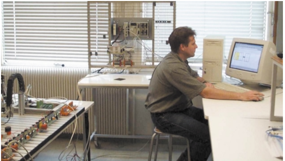
Un des deux PC, muni du logiciel Factory Cast, gère le site Web du coupleur de l'automate Micro.
